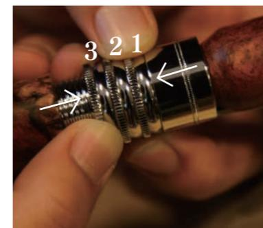
カスケットのトラウトロッドスクリーシート止め部は3連のトリプルロックスクリーシステムになっています。これはセットしたリールを固定するカスケッド独自のシステムです。使い方は以下の通り。スクリーシート及びネジ部分に砂やゴミが噛んでいないことを確認してください。リールフットをスパーサーに挿入したら1リングを止まる位置まで押し上げてください。次に2リングはネジなしのフリーリングですのでそのまま押し上げて3リングをねじ込んで止めます。いったん動かなくなるところまでねじ込んだら3リングを動かさないように押さえて1リングを下方に回します。ちょうど2リングを締め合うような具合です。この時スクリーシートは動きませんが力方向が相互に働くことによって取れにくくなります。はずす場合は3リングをしっかり持って下方にねじって外します。はずれにくい場合は2リングと一緒に握って回すと外れやすくなります。注意:決してペンチなどの金属工具でネジを回さないように締めたりしないでください。メッキが剥けたりとれなくなる原因となります。
